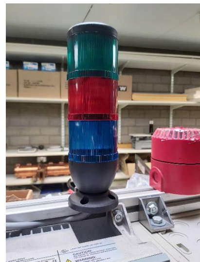
Figuur 5.2-10: Signaaltoeren op brouwinstallatie
