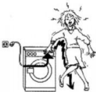
Figuur 5.7-2: Gevaar van onder spanning staande delen
