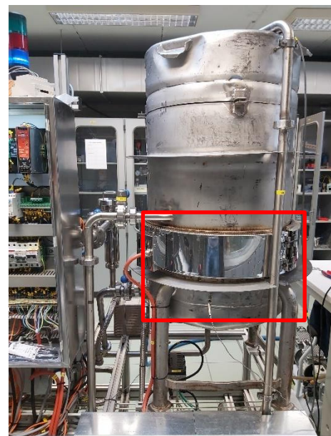
Figuur 3.8-4: Geen isolatie rond de kookketel (*mantelweerstand)
